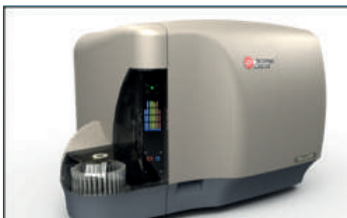
Fig. 3: il citofluorimetro in uso presso la Bios SpA capace di valutare fino a 10 fluorescenze in contemporanea. Da www.beckman.com
